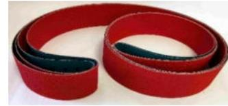
Schleifbänder mit extrem schwerer Polyesterunterlage, aggressivem Keramikkorn und Zusatzbeschichtung für einen kühlen Schliff insbesondere auf Titan, Nickelbasislegierungen und Edelstahl.
