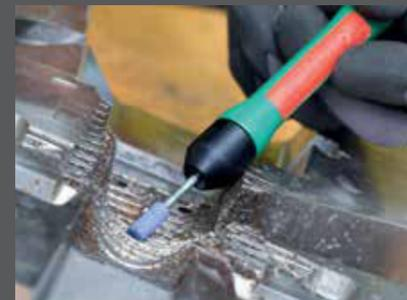
Die hochtourigen BIAX-Schleifer überzeugen dort, wo es besonders auf Durchzugskraft und ermüdungsfreies Arbeiten ankommt. Ein besonderes Merkmal unserer Maschinen mit Lamellenmotor ist die hohe Leistung bei geringem Gewicht und kleiner Baugröße. Sie liegen wie ein Schreibstift in der Hand. Im Sortiment gibt es auch ein Modell mit werkzeuglosem Frässtiftwechsel und eine Maschine mit einer speziellen Vorrichtung, um eine homogene 45° Fase zu erzeugen.
