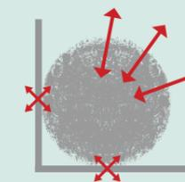
Hat der Frässtift an mehreren Stellen gleichzeitig Kontakt zum Bauteil oder ist die Kontaktfläche des Frässtifts zum Bauteil zu groß, kommt es zu Schlägen und Vibrationen.
