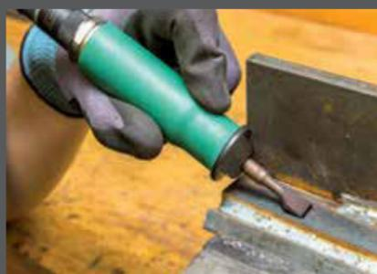
Die Maschinen eignen sich hervorragend zum Nachbearbeiten im 3D Druck, Entfernen von Schweißrückständen und Gravieren.
