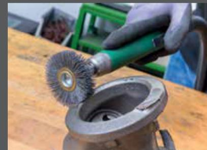
Die Bürstmaschinen gibt es in gerader oder gewinkelter Ausführung. Sie zeichnen sich durch niedrige Drehzahlen und ein hohes Drehmoment aus. Sie eignen sich insbesondere zur Entfernung loser Grate oder der Reinigung von Oberflächen und Schweißnähten.
